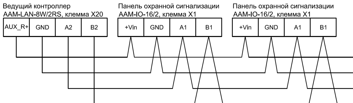
Рисунок 3. Подключение панелей охранной сигнализации ААМ-IO-16/2, подключаемых на один шлейф к ведущему ААМ-LAN-8W/2RS.
